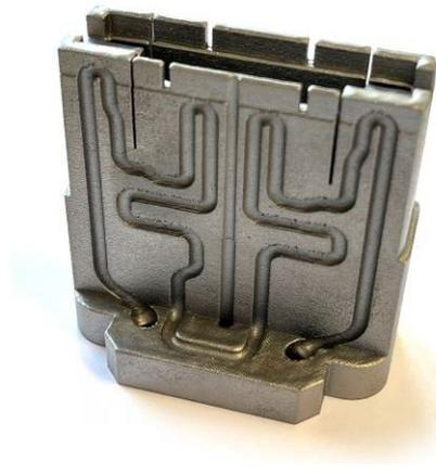
Abbildung 6: Schnitt durch einen konturnah temperierten Einsatz – nur mit Metall 3D Drucker herstellbar (Quelle: H&B Electronic)
