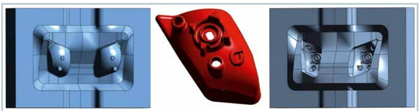
**Bild 1.** Feste (links) und bewegliche (rechts) Hälfte eines 2-fach-Werkzeugs für Scheinwerferreflektoren aus BMC (© Sigma Engineering)
